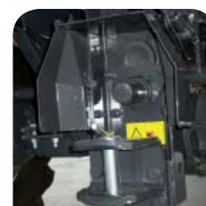
Fig. 12 - Presa di potenza posteriore con protezione e gancio di traino con spina di fermo per motoagricola
