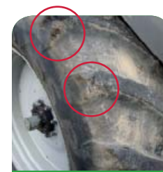
Foto 22 – Pneumatici particolarmente usurati e battistrada rovinati.
