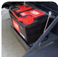
Fig. 7 - Batteria elettrica opportunamente isolata su motoagricola
