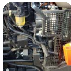
Fig. 9 - Protezione con griglia per cinghie motore e ventola di raffreddamento
