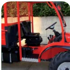
Fig. 6 - Pedana di salita al posto guida per motoagricola
