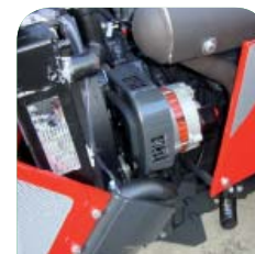
Fig. 10 - Protezione con fessure per cinghia alternatore motore
