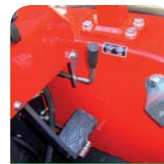
Foto 23 – Gancio di sicurezza per comando di movimentazione pianale su motoagricola.
