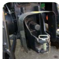
Fig. 11 - Presa di potenza posteriore con protezione e gancio di traino con spina di fermo e catenella per trattore agricolo
