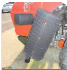
Foto 14 – Protezione con griglia per marmitta di scarico motore per motoagricola.
