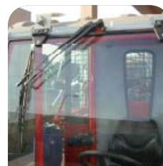
Foto 17 – Tergicristallo azionato da motorino elettrico su cabina per motoagricola.
