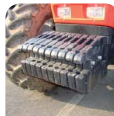
Foto 15 – Zavorre anteriori opportunamente posizionate e fissate su trattore agricolo.
